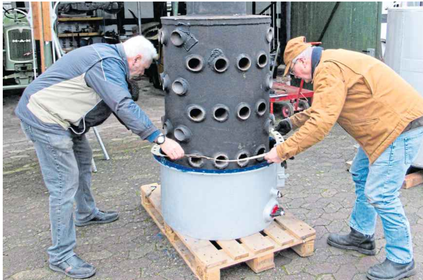
Der Kartoffeldämpfer ist repariert. Fred Eikötter (links) und Heinrich Wilhelm Kreimer legen vor dem Zusammensetzen eine neue Dichtung auf. Auf den Dichttring haben sie reichlich blaue „Hylomar“-Paste aufgetragen.
