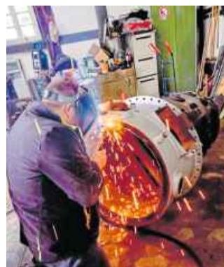
Christian Kröger schweiß mit Schutzgas ein Blech in die Brennkammer ein.
