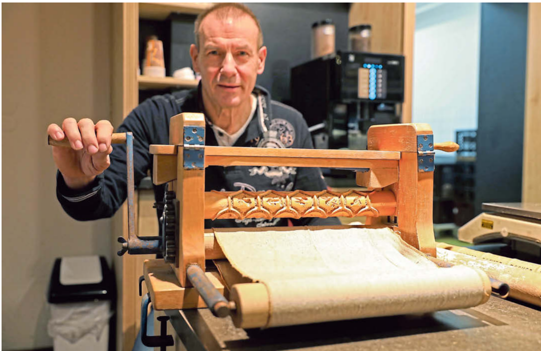
Bäckermeister Volker Erdbrügger zeigt die Handkurbel-Keksmaschine seines Vorgängers Helmut Schröder. Für die Arbeit daran waren zwei Leute nötig. Sie bereiteten zwanzig bis dreißig Kilo Teig vor und drehten ihn abschnittsweise durch die Maschine. Foto: Frank-Michael Kiel-Steinkamp
