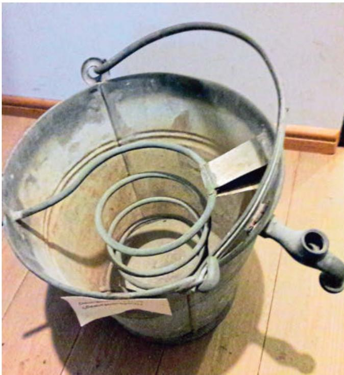
Ist der Eimer mit kaltem Wasser gefüllt, wird die Rohrschlange abgekühlt und der durchströmende Dampf kondensiert. FOTO: MÖRSTEDT
