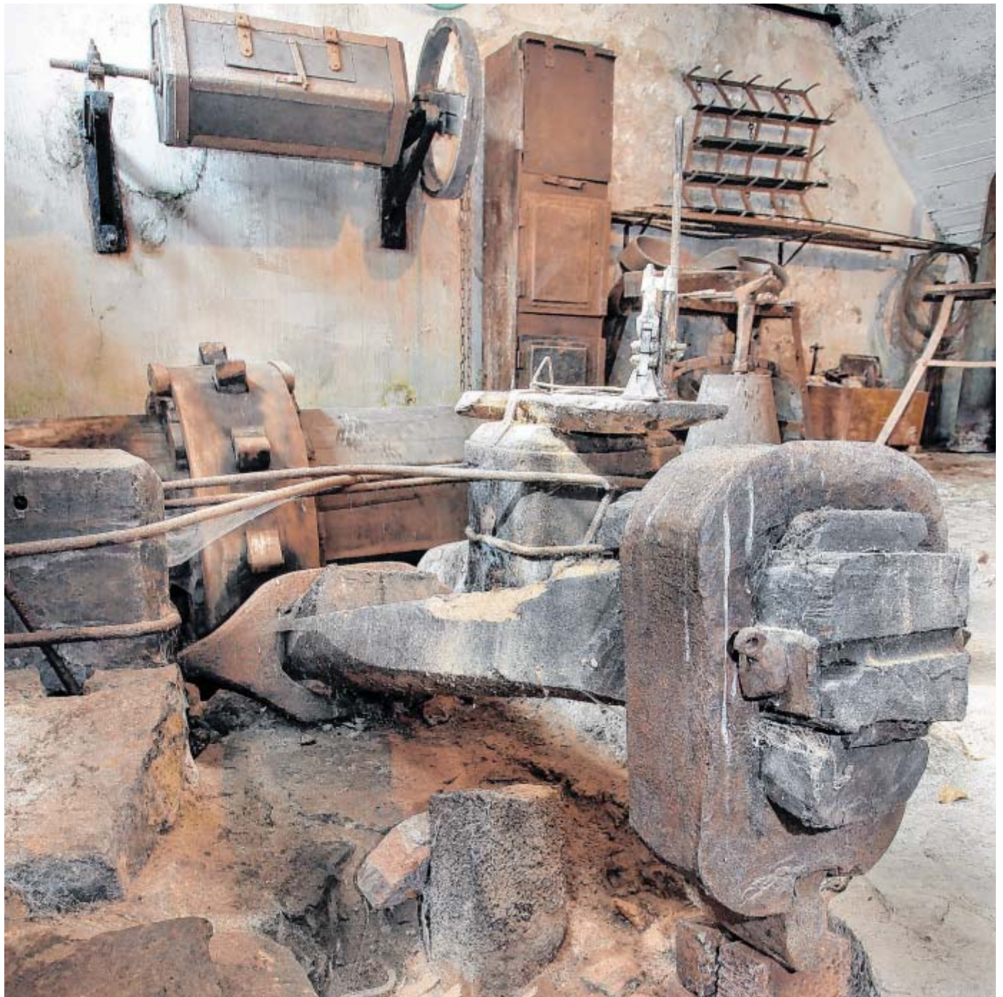
Der Hammer: Die Maschine besteht aus dem Kopf (vorne), dem Stiel und der Nockenwelle (im Hintergrund). Sie wird von einem Wasserrad angetrieben. Die Schmiede von Valdorf stellten mit ihrer Hilfe Spaten, Schaufeln und manches andere her. FOTO: FRANK-MICHAEL KIEL-STEINKAMP
