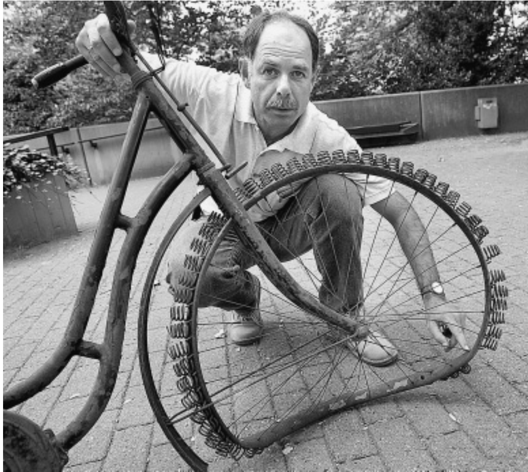
Ende einer Testfahrt: Beim Absteigen knickten die Felgen. Mittlerweile haben die Schrauber vom MSCH das Spiralala repariert – die Felgen sind wieder gerade gebogen.
