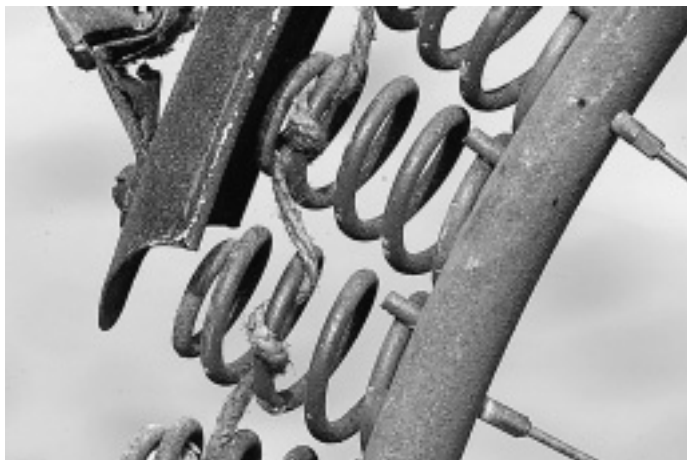
Notbehelf: Um nicht auf der Felge zu rollen, übernehmen Spiralfedern die Aufgabe der Reifen. Ein umlaufendes Band hält sie in der Reihe.
