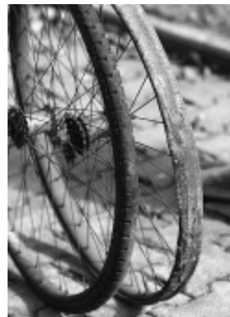
Noch mehr Nachkriegs-Alternativen: Links ein Vollgummi-, rechts ein flach gefahrener Reifen.
