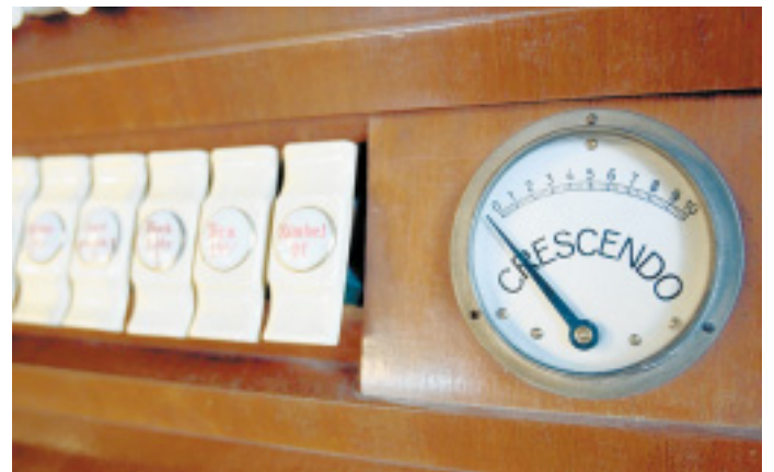
Originalzustand: Neben den Registerwippen befindet sich die Crescendo-Anzeige. Sie zeigt an, wie viele Register eingeschaltet sind.
