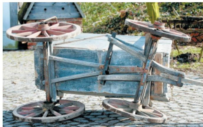
**Raffiniert konstruiert:** Der Wagenkasten ist von der Unterkonstruktion aus Buchenholz mit Drehschemel-Lenkung komplett abnehmbar.
