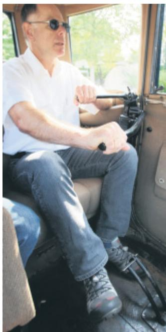
**Im Griff:** Mit Rechts wird gelenkt, mit Links der Antrieb geregelt. HF-Testfahrer Mörstedt versucht es.
