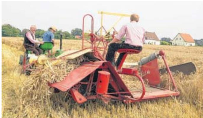
**Erst mähen, dann binden:** Die komplizierte Maschine wirft alle drei Meter eine Garbe nach links ab.
