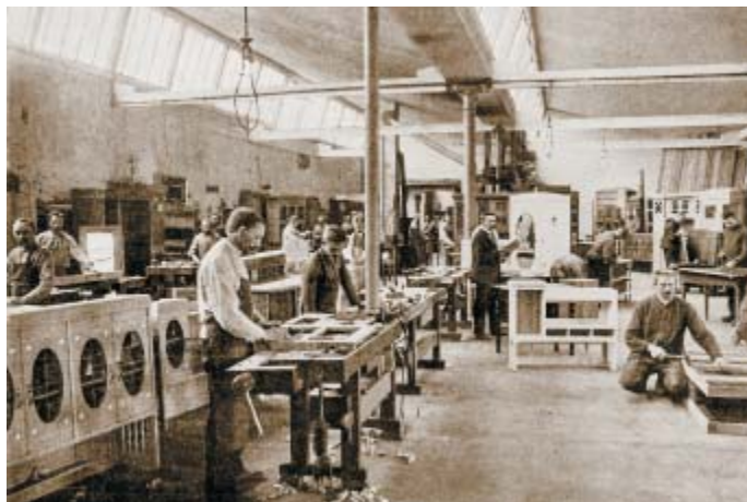
Unterm Sheddach: Einfache Küchenschränke bauten die Kopka-Leute in großen Serien. Bei der Montage war noch viel Handarbeit gefragt.
