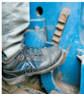
Fußbremse: Das Pedal rastet zwischen den Zähnen ein.
