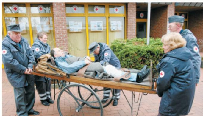
**Mit Schwung:** Liegt der Patient, heben die Helfer an und die Achse schwenkt unter die Fahrzeugmitte. So ausbalanciert, lässt sich das Gefährt leicht und sicher um die Ecken bewegen.
